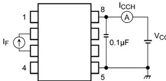
**Fig. 13.1.5 I<sub>CCH</sub> Test Circuit**
