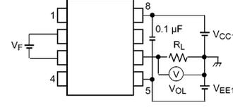
**Fig. 13.1.4 V<sub>OL</sub> Test Circuit**
