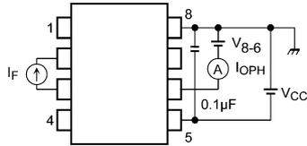
**Fig. 13.1.1 I<sub>OPH</sub> Test Circuit**
