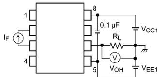
**Fig. 13.1.3 V<sub>OH</sub> Test Circuit**
