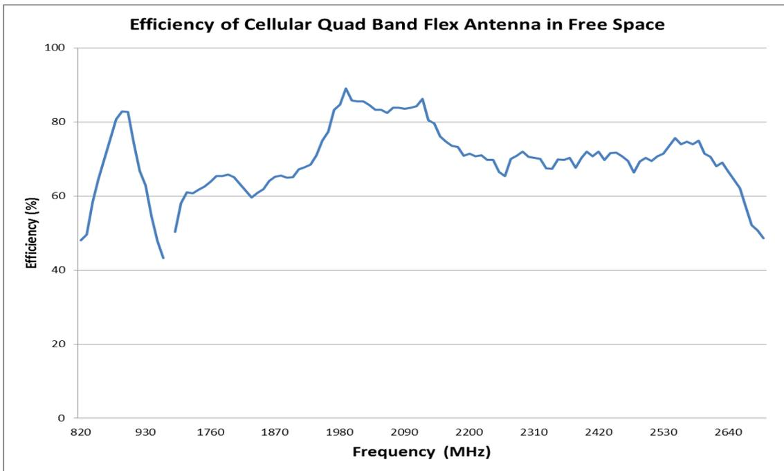
**FIGURE 2.3 EFFICIENCY OF ANTENNA IN FREE SPACE**
