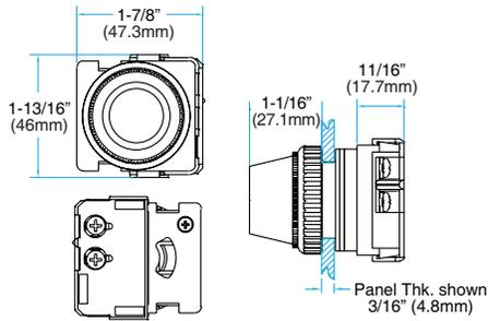
**RESISTOR PILOT LIGHT OPERATOR**
