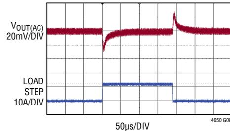
12V<sub>IN</sub>, 1.8V<sub>OUT</sub>, 600kHz, 12.5A LOAD STEP
