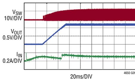
12V<sub>IN</sub>, 1.2V<sub>OUT</sub>, 500kHz
