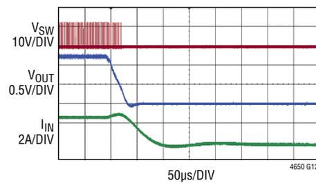
12V<sub>IN</sub>, 1.2V<sub>OUT</sub>, 500kHz
