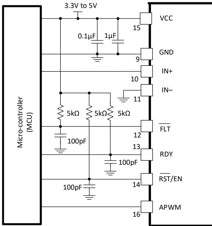
**Figure 46.  $\overline{\text{FLT}}$ , RDY and  $\overline{\text{RST/EN}}$  Pins Circuitry**
