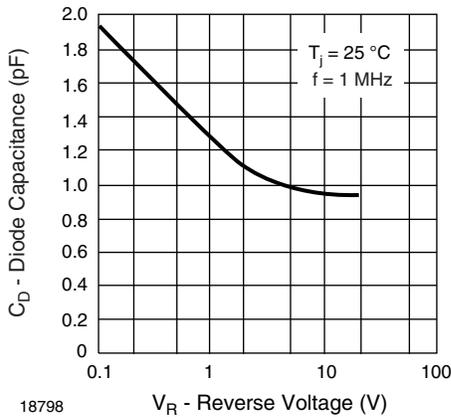
Fig. 1 - Diode Capacitance
