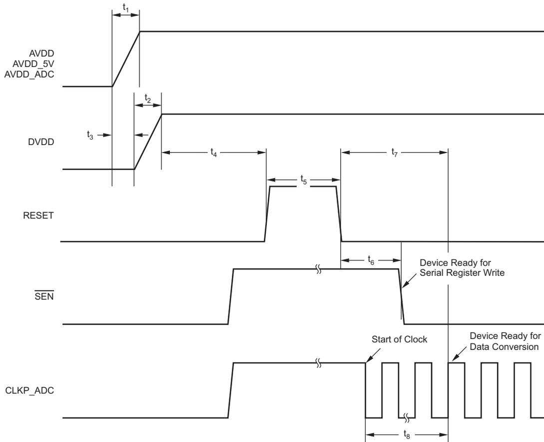
$10 \mu\text{s} < t_1 < 50 \text{ ms}$ ,  $10 \mu\text{s} < t_2 < 50 \text{ ms}$ ,  $-10 \text{ ms} < t_3 < 10 \text{ ms}$ ,  $t_4 > 10 \text{ ms}$ ,  $t_5 > 100 \text{ ns}$ ,  $t_6 > 100 \text{ ns}$ ,  $t_7 > 10 \text{ ms}$ , and  $t_8 > 100 \mu\text{s}$ .
