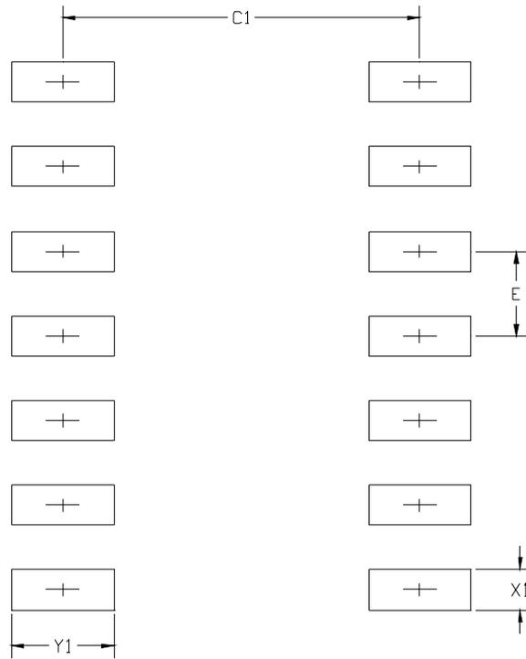
**Figure 4.7. SOIC-14 PCB Land Pattern**
