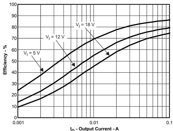
$V_{OUT2} = 1.5\text{ V}$
