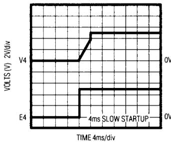
REGULATOR 4  $V_{OUT}$  0V TO -5V
