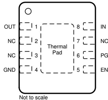
**Figure 5-4. DRB Package, 8-Pin Fixed VSON (Top View)**
