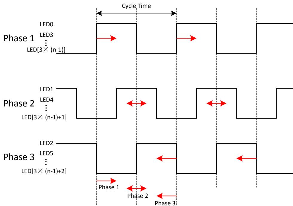
**Figure 12. PWM Phase-Shifting**
