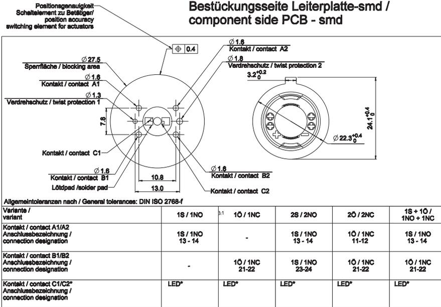
Die Schaltung der Kontakte erfolgt nach folgendem Schema: /
