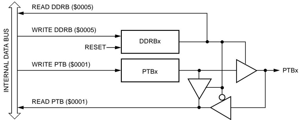
Figure 16-8. Port B I/O Circuit
