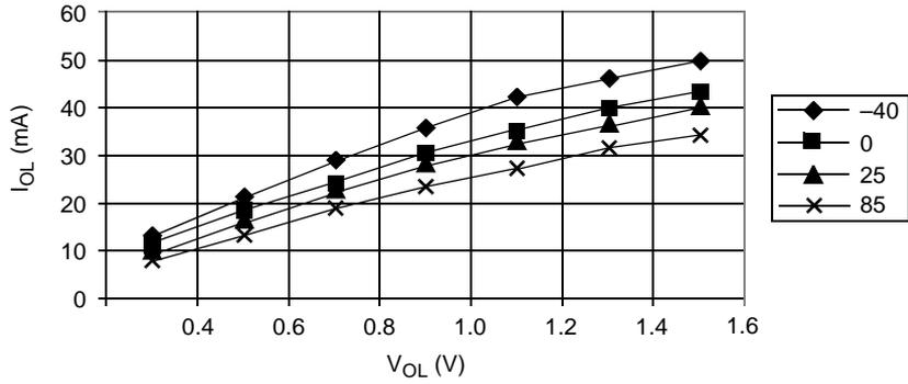
$V_{OL} < 1.0$  V @  $I_{OL} = 15$  mA
