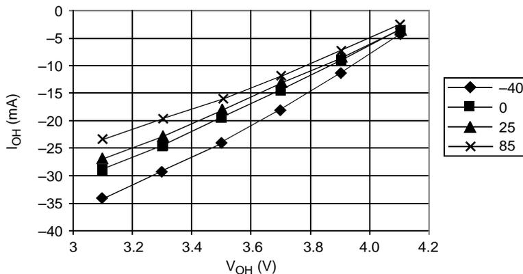
$V_{OH} > V_{DD} - 0.8\text{ V}$  @  $I_{OH} = -10.0\text{ mA}$
