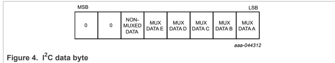
Figure 4. I<sup>2</sup>C data byte
