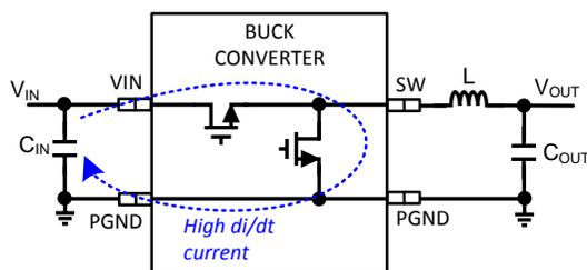
**Figure 100. Buck Converter High di / dt Path**
