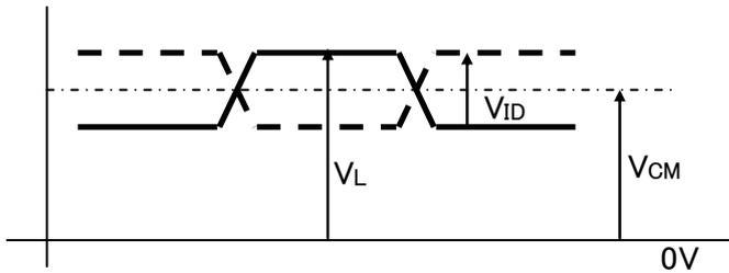
5)  $V_{CM}$  : LVDS Common mode voltage ( $V_{CM}=1.25V$ )
