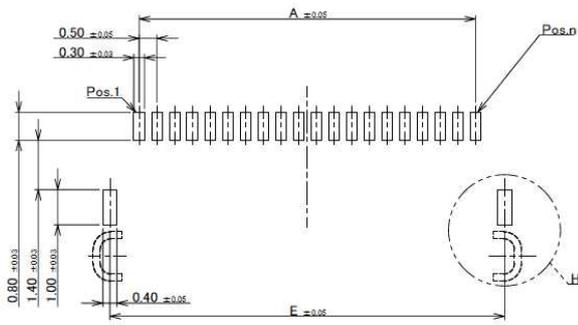
RECOMMENDED PCB LAYOUT & METAL MASK LAYOUT
