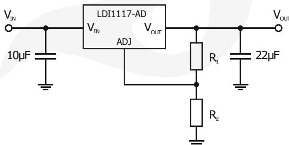
**Fig. 1** Typische Anwendungsschaltung für einen einstellbaren Spannungsregler
